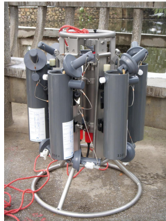
采水前的多通道水样采集器 Slimline
